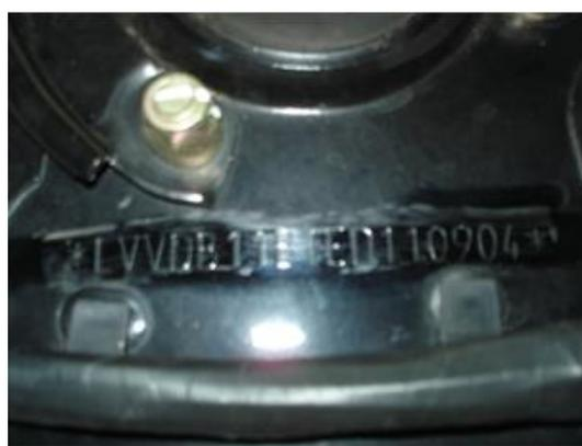
Рис. 3. Расположение идентификационного номера в моторном отсеке автомобиля
