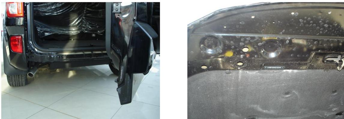
Рис. 4. Расположение идентификационного номера на задней двери и капоте автомобиля
