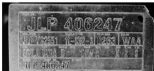
Рис. 10. Полимерная табличка с обозначениями, в том числе и номера кузова, на заднем левом стекле
