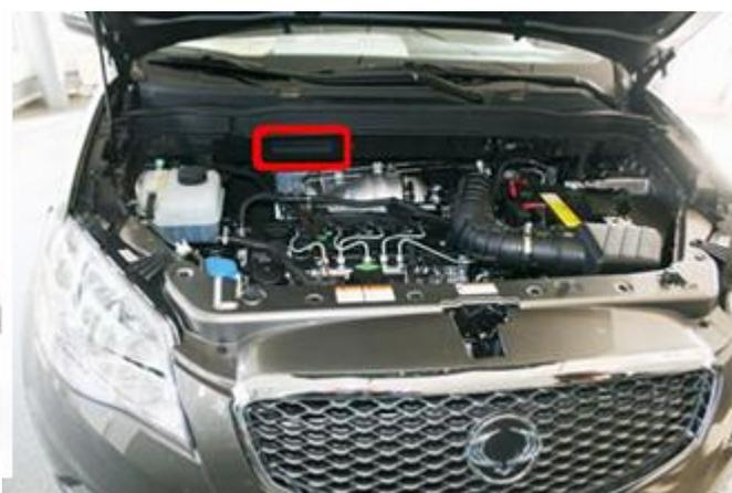
Рис. 2. Место нанесения идентификационной маркировки на перегородке моторного отсека со стороны переднего пассажира
