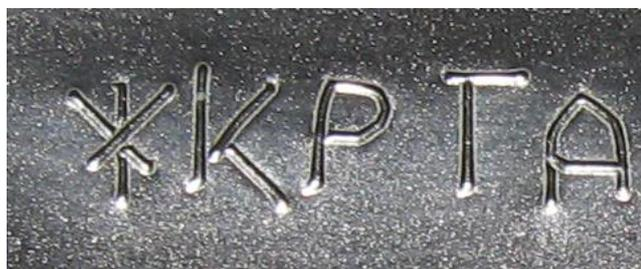
Рис. 6. Фрагмент маркировки VIN-номера методом гравирования твёрдосплавной иглой
