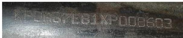
Рис. 4 Маркирование панели рамы методом кернения точками
