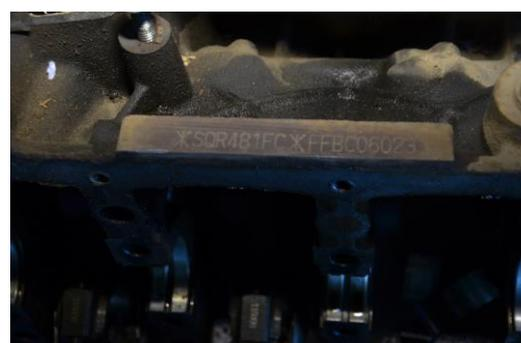
Рис. 6. Расположение маркировки двигателя
