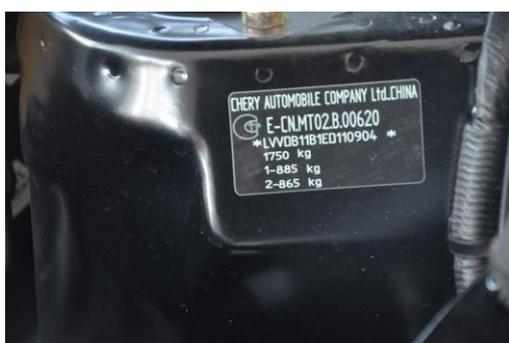
Рис. 5 Расположение и внешний вид заводской таблички автомобиля
