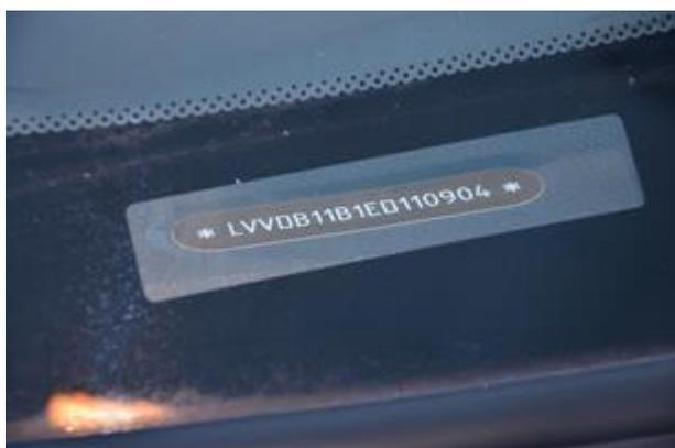
Рис. 2. Расположение и внешний вид идентификационного номера автомобиля
